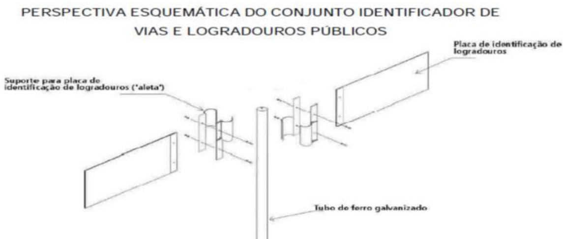
Figura 01: Perspectiva esquemática da fixação de placas de logradouro.
